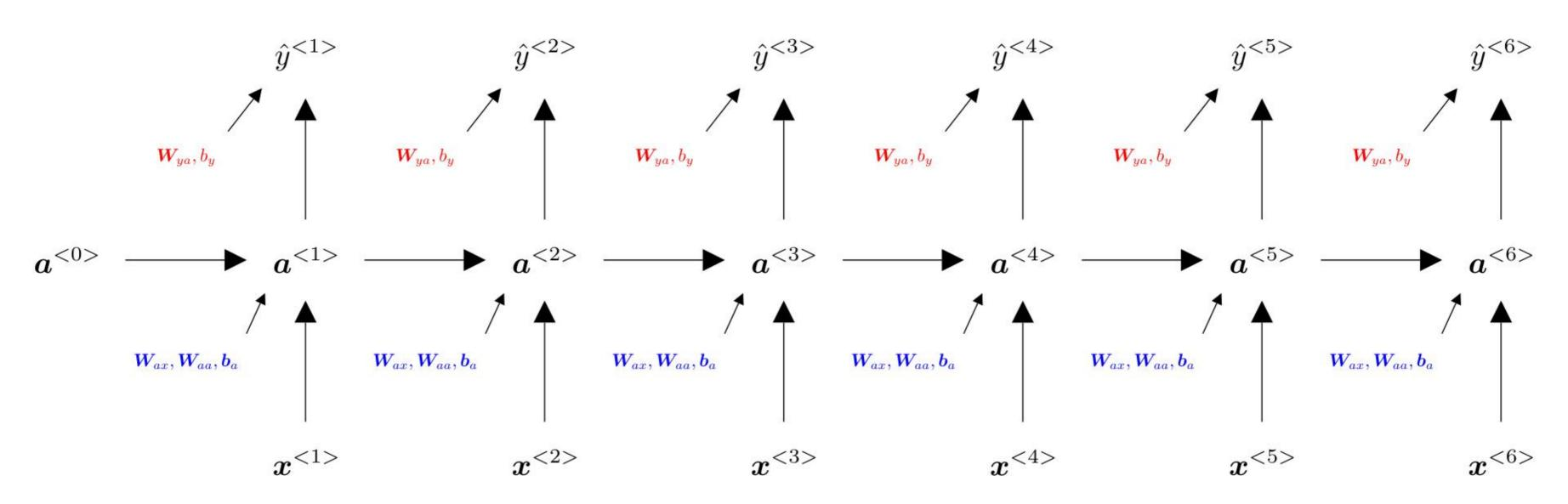
$$a^{\langle i \rangle} = \sigma_{ax} (W_{ax} x^{\langle i \rangle} + W_{aa} a^{\langle i-1 \rangle} + b_a) \quad (i = 1, \dots, 6)$$
